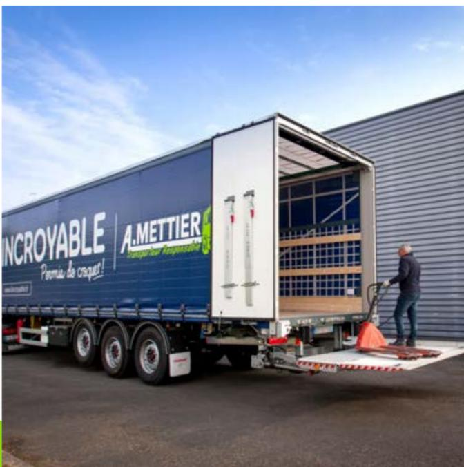
Capacité de levage : 2 tonnes
